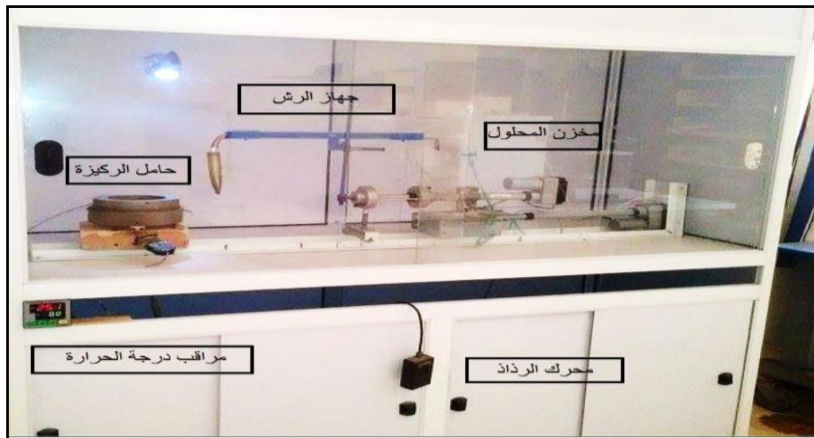
الشكل(III-4): التركيب التجريبي لترسيب الأغشية الرقيقة بتقنية الرش الحراري
