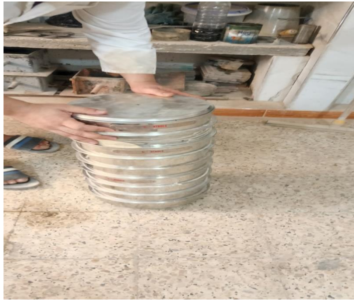
Figure 3: Processus de secouage des tamis
