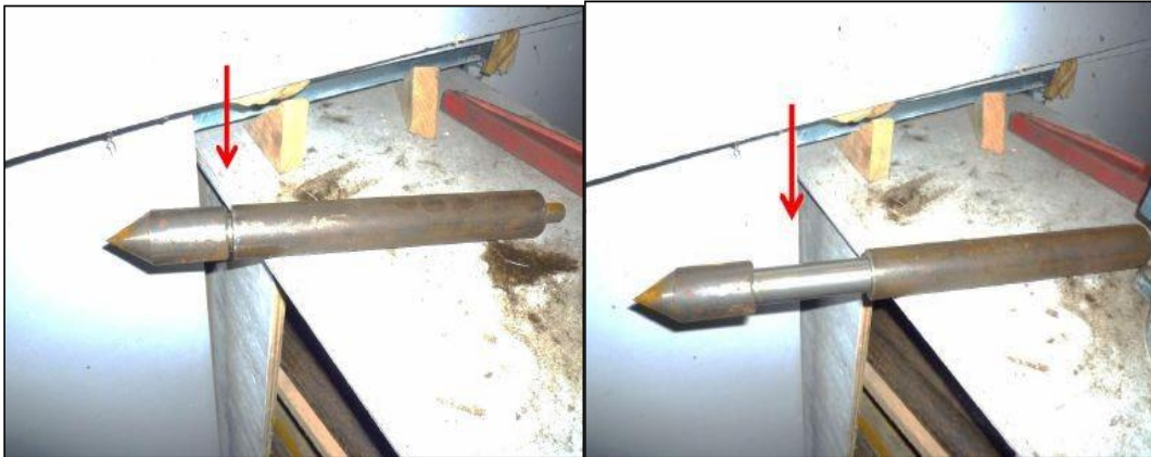
Figure 12: Photos D'une Pointe Du Pénétrömètre Statique
