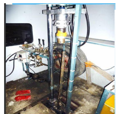
Figure 9: Le camion à pénétromètre Figure 10: Le camion à pénétromètre Figure 11: Pénétromètre Statique
