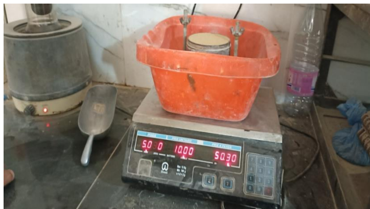
Figure 13 : Le poids du moule + base + sol compacté est pris (w2)
