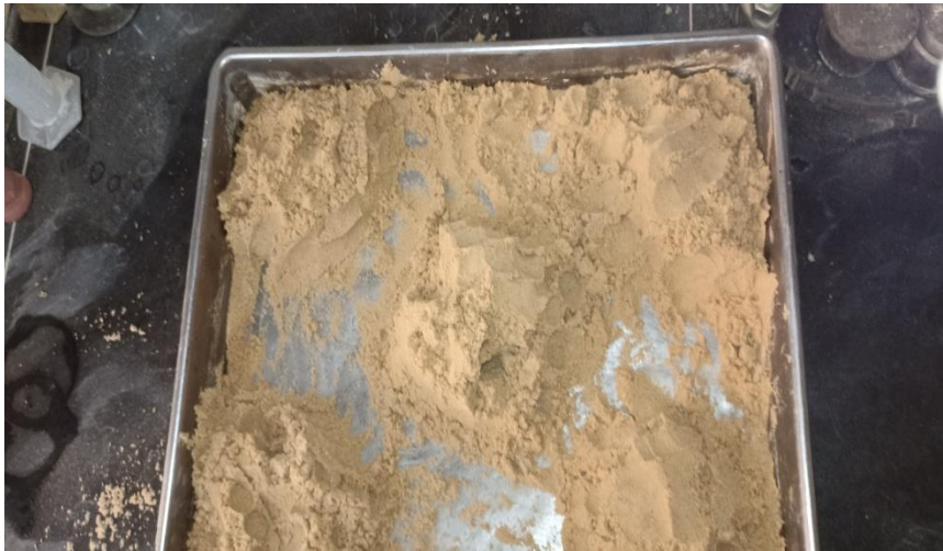
Figure 12 : Diviser l'échantillon en 5 parties
