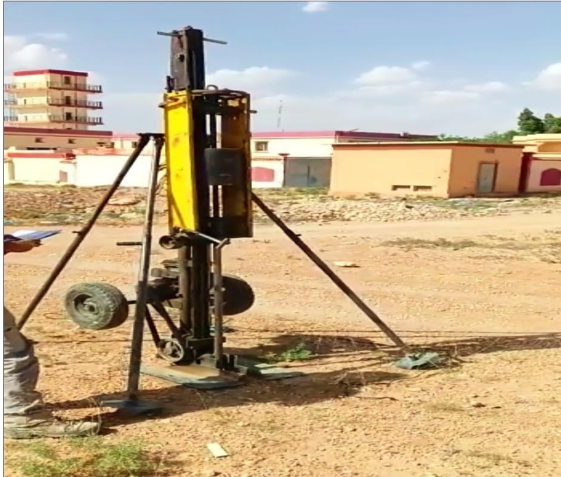
Figure 7 : Réalisation de l'essai de pénétration sur un terrain.
