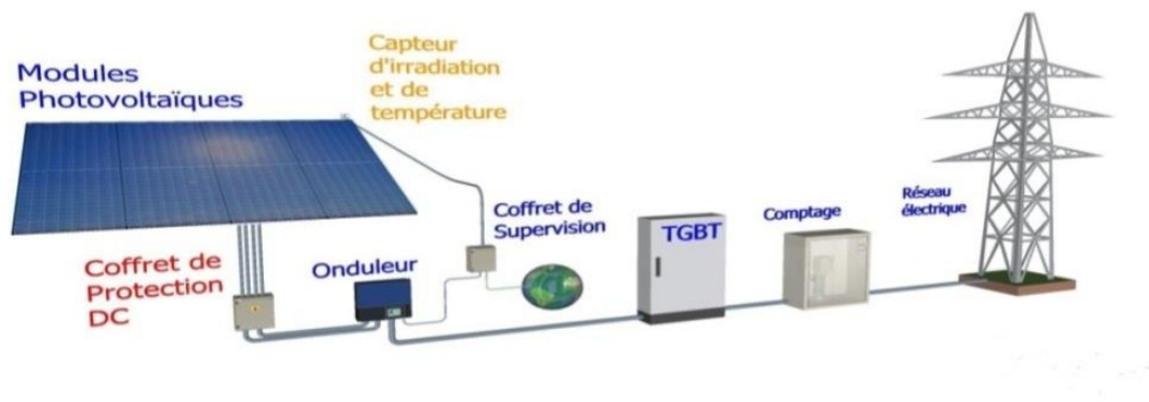
Figure (1.3) : Structure d'un système PV connecté au réseau.[2]
