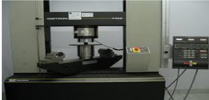
Figure 2.21 : Rupture par Compression Diamétrale.
