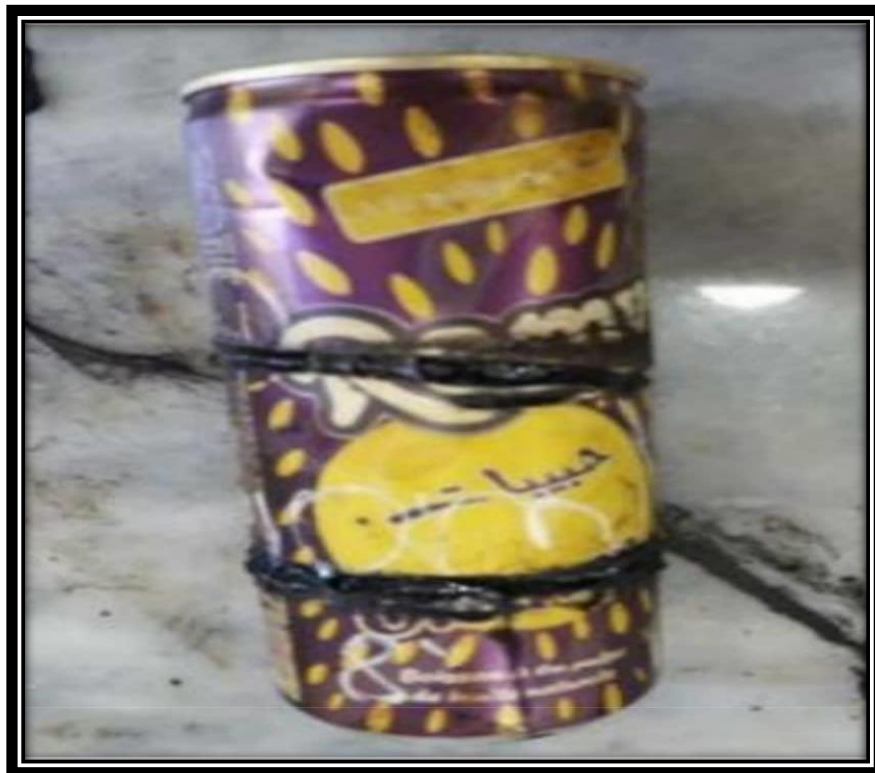
Figure 5.6 : Prélèvement d'éprouvettes pour l'essai de stabilité au stockage.
