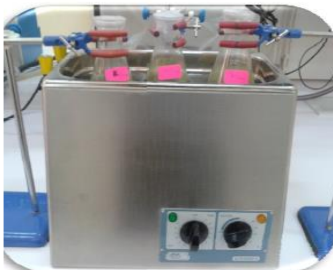
Figure (9) : Extraction par ultrason
