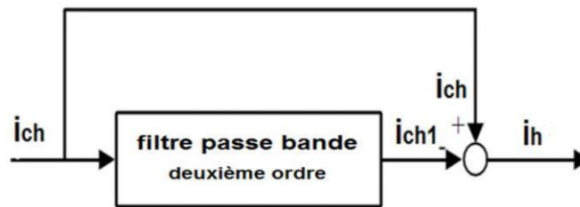
Figure III.4 : Schéma de principe d'identification des courants harmoniques. [25]
