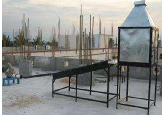
Figure I. 3 : La configuration expérimentale du séchoir solaire [29].
