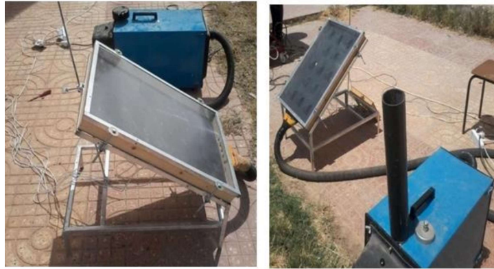
Figure II.16 : Montage expérimental (avec et sans ailerons). [21].
