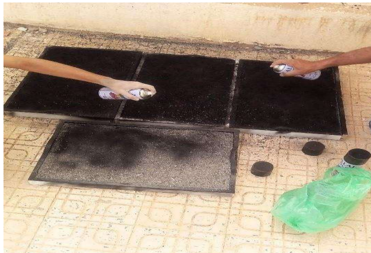
Figure III. 8 : Peindre les feuilles avec de la peinture noire mate.
