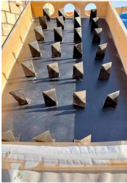
Figure I.26 : Forme et emplacement des chicanes étudiées.
