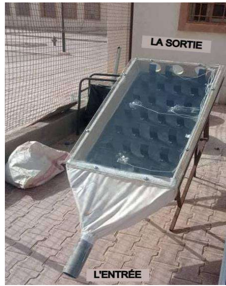
Figure I.25 : Isolation thermique des longueurs d'entrée
