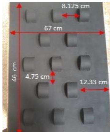
Figure II.17 : Absorbeur chicanes de forme semi-cylindrique [21].
