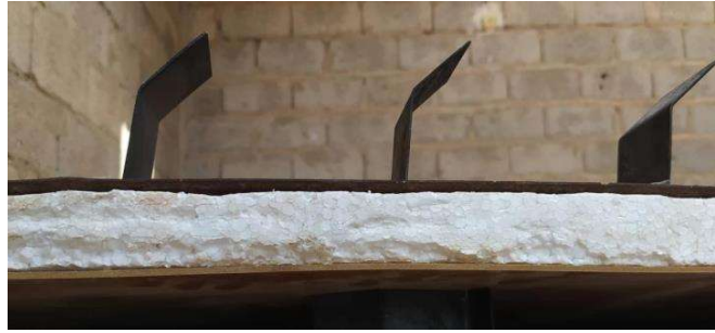
Figure I .24 : Isolation thermique du capteur plan à air [30].
