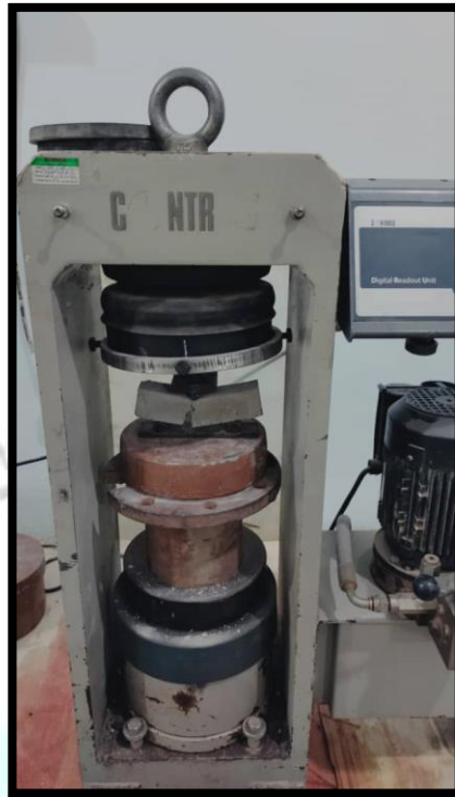
Figure IV-9 /essais du traction pare flexion – éprouvette( 4*4*16)
