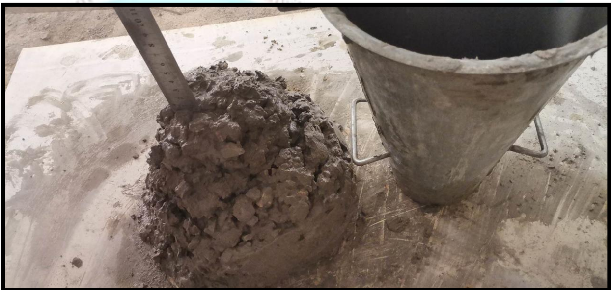
Figure IV-1 / Essai d'affaissement au cône d'Abrams
