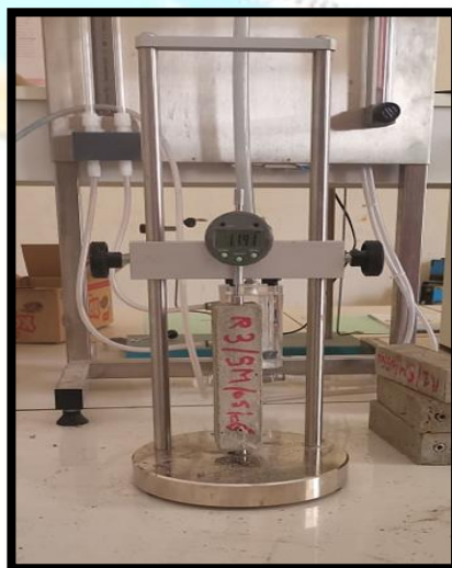
Figure IV-12 / mesure du retrait du un échantillon prismatique
