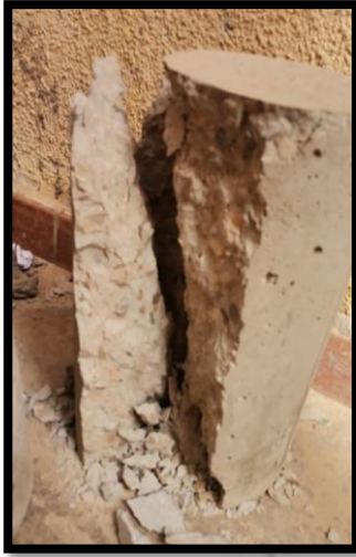
Figure 0-14 / Eprouvette écrasé pare compression
