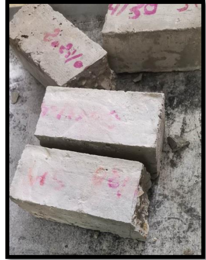
Figure 0-13 / Eprouvette écrasé traction par la flexion
