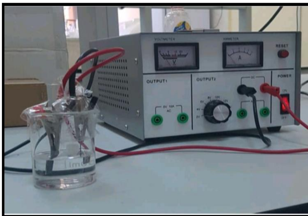
الشكل (III-1): طريقة تحضير المحلول شوارد الزنك بطريقة كهروكيميائية.
