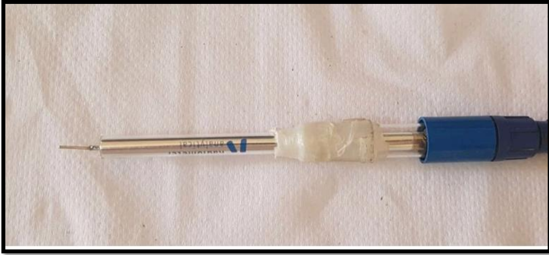
الشكل (12-11): قطب البلاتين المساعد (AE).
