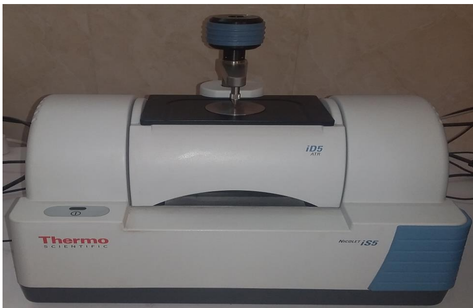
الشكل (8-IV): طريقة وضع العينة في جهاز IR-ATR .
