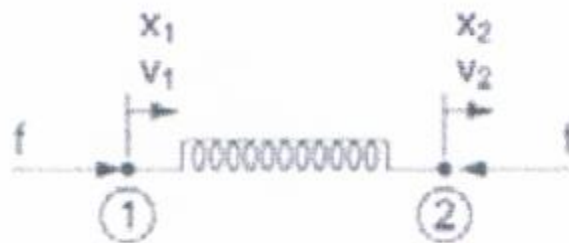
Figure 4: 8 Symbole mécanique du ressort en translation.
