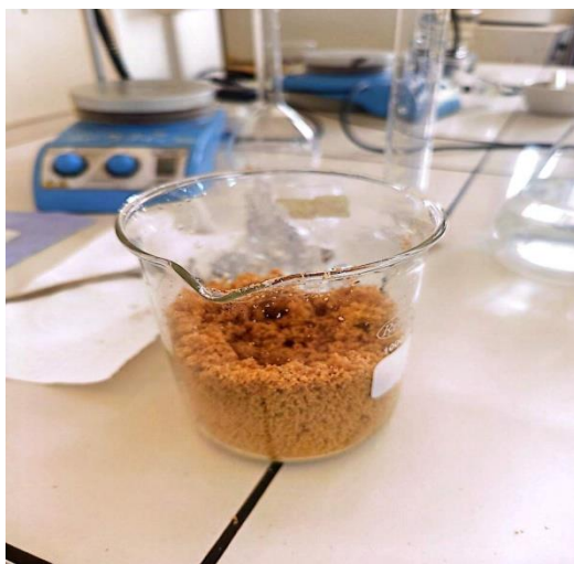
Figure II.4: Poudre de coques d'arachide après séchage et traitement acide par HCl.
