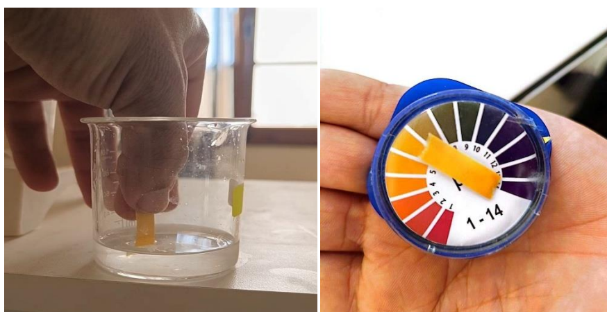
Figure II.3 : Mesure du pH après traitement et vérification de la neutralité du milieu à l'aide de papier pH.
