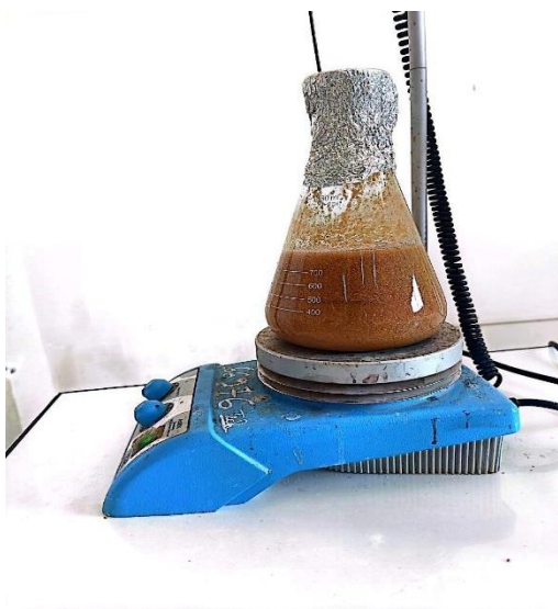
Figure II.2 : L'agitation des coques d'arachide au cours du traitement chimique.
