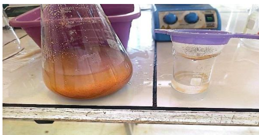
Figure II.5 : Lavage et séparation des coques d'arachide traitées chimiquement sur tamis en plastique.
