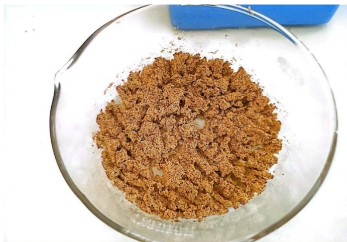
Figure II.6: Poudre de coques d'arachide ( C_{ArA} ) après séchage et traitement alcalin par la NaOH.
