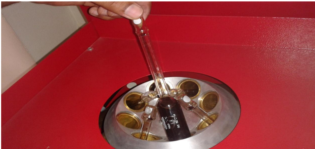
Figure 19 : Mise en place des butyromètre dans la centrifugeuse de gerber.
