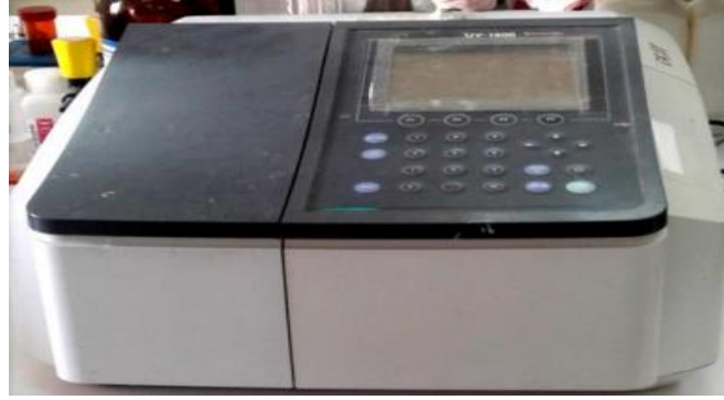
الشكل (III-12): جهاز التحليل الطيفي (UV-VIS).
