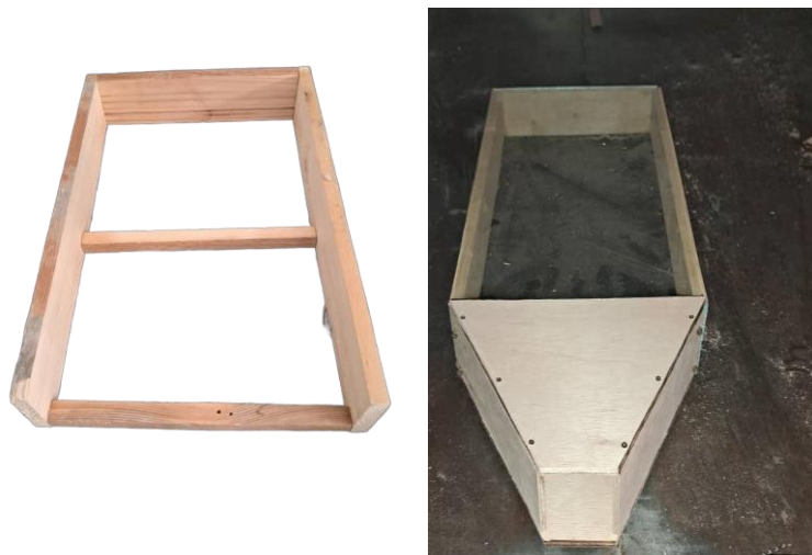
Figure III-3: Cadre de capteur plan à air
