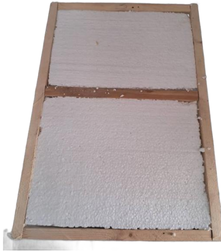
Figure III-2: Isolation thermique du capteur plan à air
