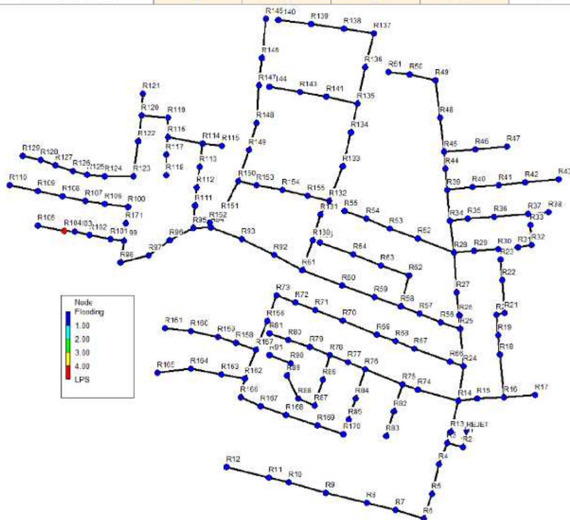
Figure V.3 : Exemples de débordements aux nœuds critiques ( T = 2 ans, Horizon 2025)
