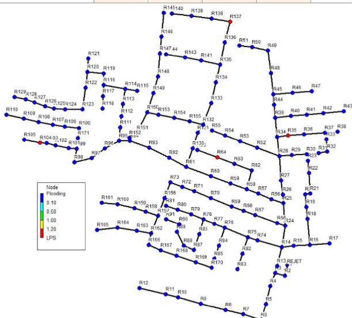
Figure V.7 : Exemples de débordements aux nœuds critiques ( T = 10 ans, Horizon 2025)
