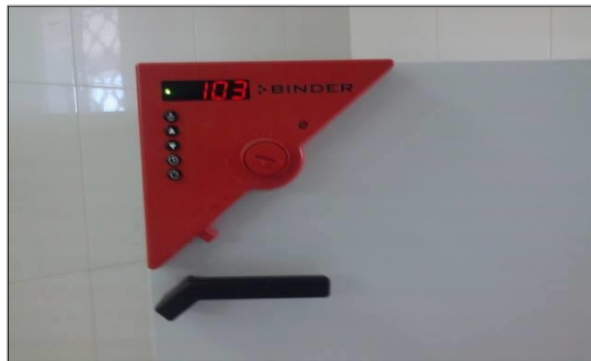
Figure 07 : Photo d'une étuve utilisée pour le séchage du lait (Photo originel, 2015).
