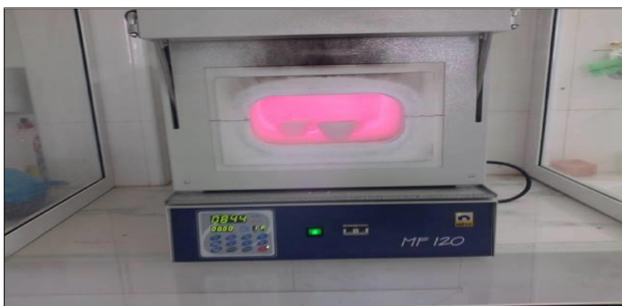
Figure 10 : Le Four électrique pour chauffage d'échantillon (Photo originel, 2015).
