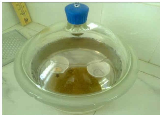
Figure 08 : Photo d'un dessiccateur de capsule (Photo originel, 2015).
