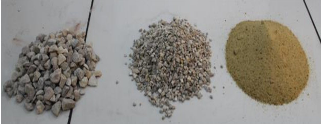
الشكل (III-1): عينات من الرمل (5/0) ، الحصى (8/3) ، الحصى (15/8) .
