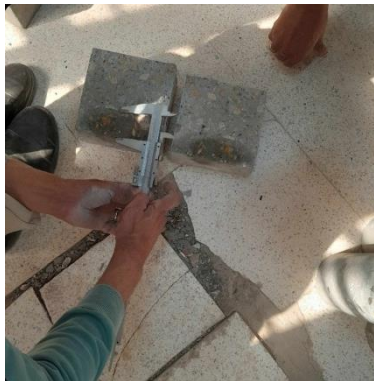
الشكل (14-IV): اختبار نفاذية الماء للخرسانة .
