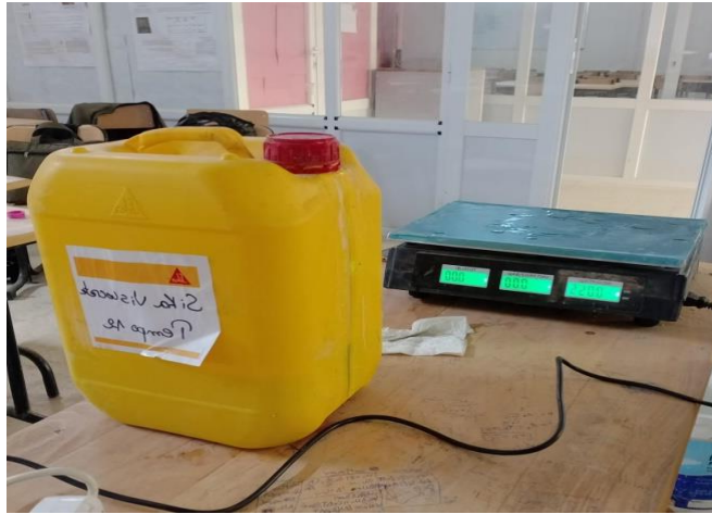
الشكل (III - 6): نوع المحسن الفائقة المستعمل في الخلط .
