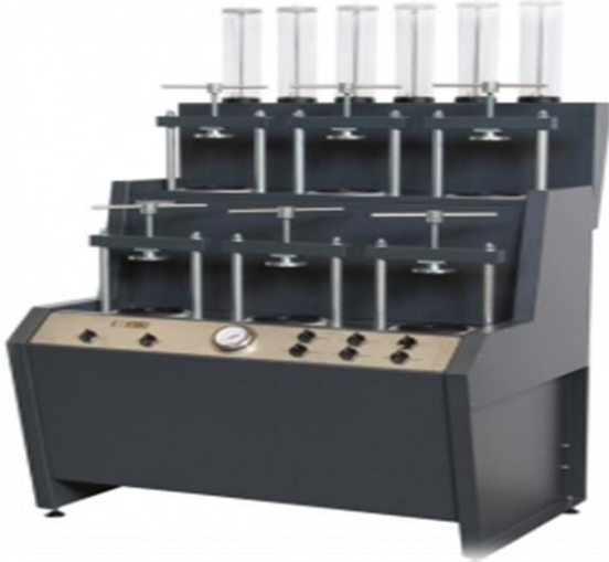
الشكل (I - 10) : قياس عمق اختراق الماء الشكل (I - 9) : جهاز نفاذية الماء للخرسانة .
