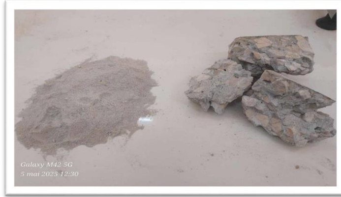
الشكل (III-13): نفايات الخرسانة قبل و بعد عملية طحنها .
