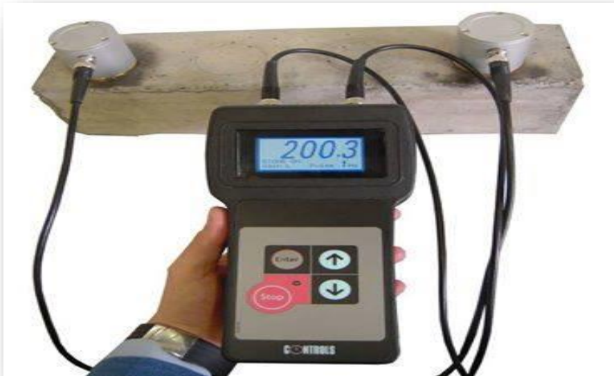
الشكل (1-6): جهاز قياس الموجات الصوتية.
