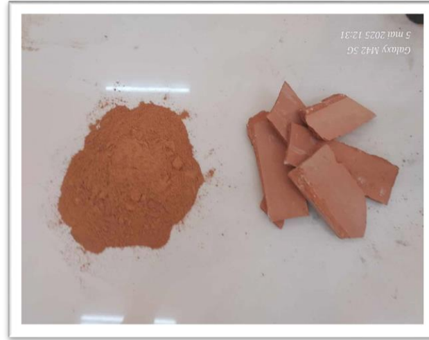
الشكل (III-7): نفايات الأجر قبل و بعد عملية طحنها .
