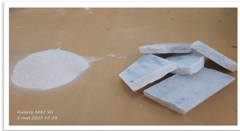
الشكل (III - 9): نفايات الرخام قبل و بعد عملية طحنها .
