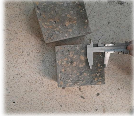
الشكل (I - 10) : قياس عمق اختراق الماء الشكل (I - 9) : جهاز نفاذية الماء للخرسانة .
