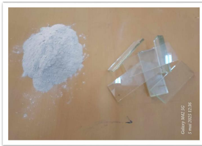
الشكل (III - 11): نفايات الزجاج قبل و بعد عملية طحنها .
