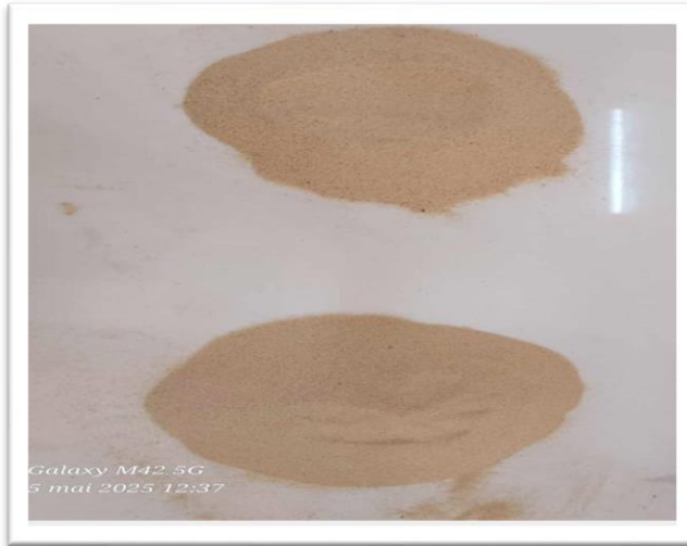
الشكل (III-15) : رمال الكثبان قبل و بعد عملية طحنها .
