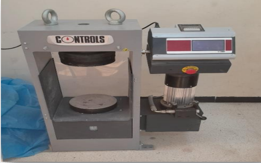
الشكل (I- 11) : جهاز قياس قوة الضغط .
