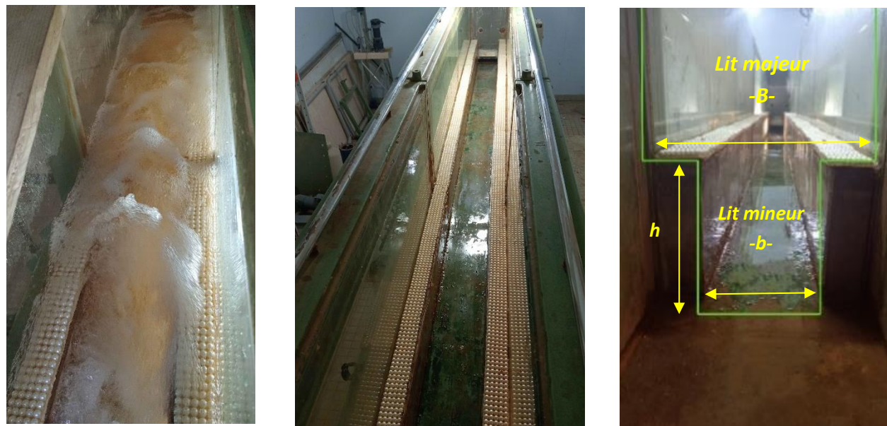
Photo I.2. La section composée du canal avec lit majeur rugueux
