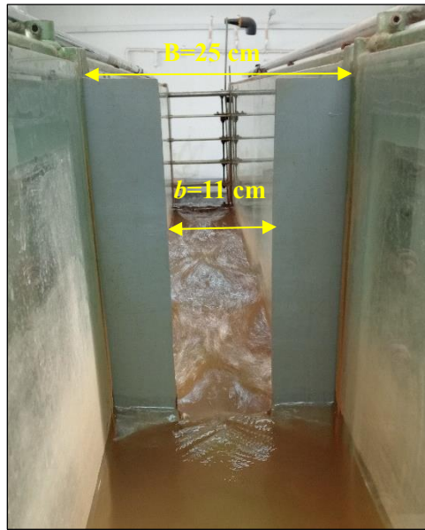
Photo I.7. Déversoir de section rectangulaire pour mesurer des débits volumiques.
