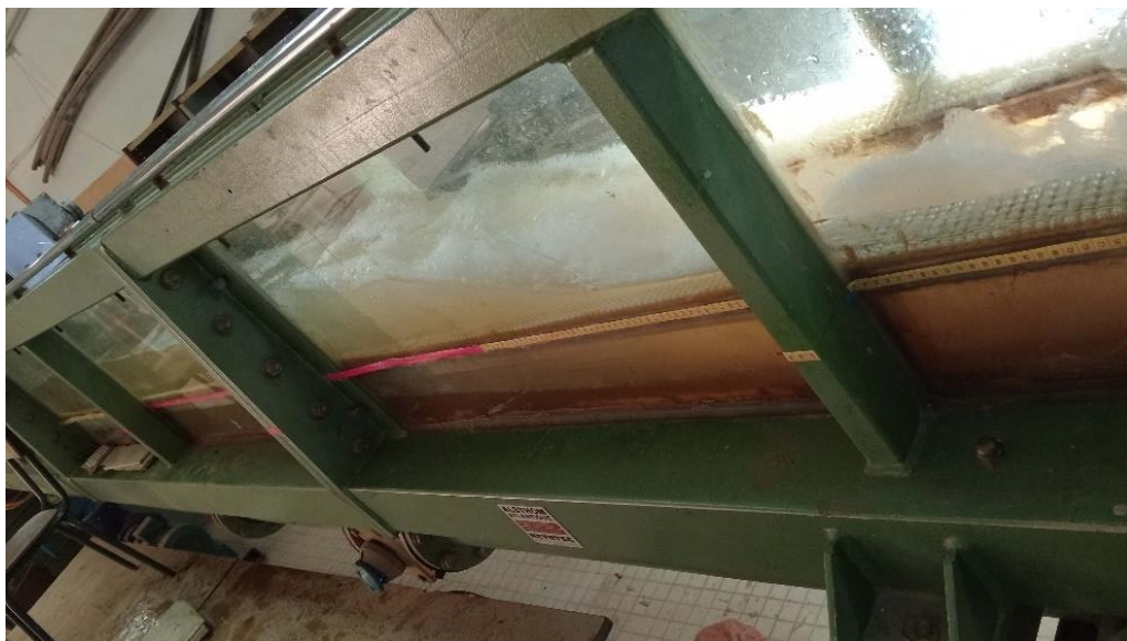
Photo I.1. Ressaut hydraulique évoluant dans canal rectangulaire composé.
