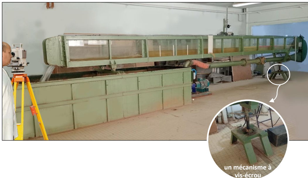
Photo I.10. vue d'ensemble du canal d'essai et le mécanisme à vis-écrou
