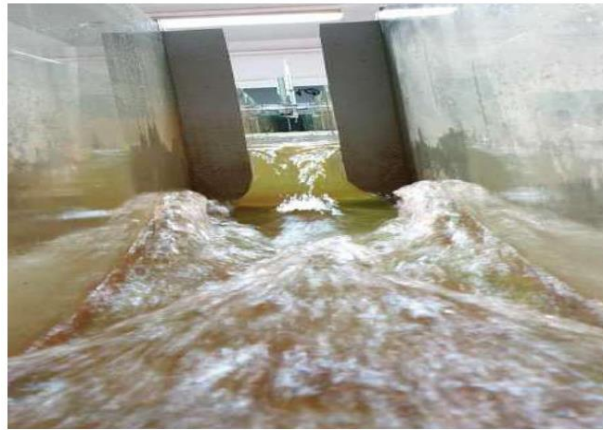
Photo II.1 : dispositif de mesure des débits volumiques
