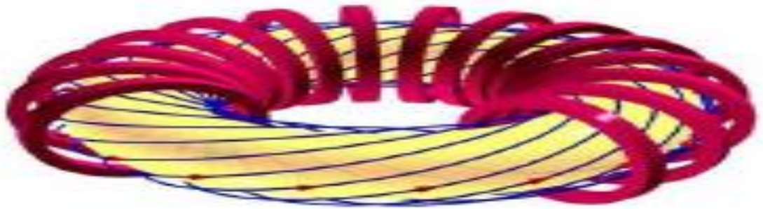
Figure 1-2: Configuration Tokamak pour les plasmas de fusion magnétique. Les lignes bleues représentent les lignes de champ magnétique [8].
