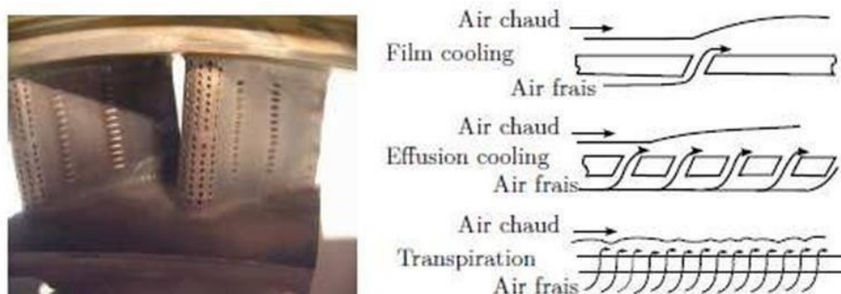
Figure I.15 : Refroidissement par film [17]
