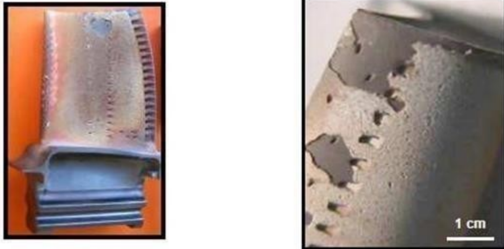
Figure I.18 : Ecaillages de la couche de céramique de systèmes barrière thermique pour aube [18]
