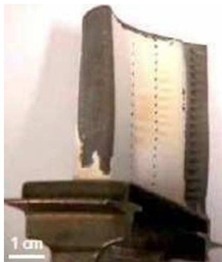
Figure I.19 : Disparition de la couche de céramique par érosion [18]
