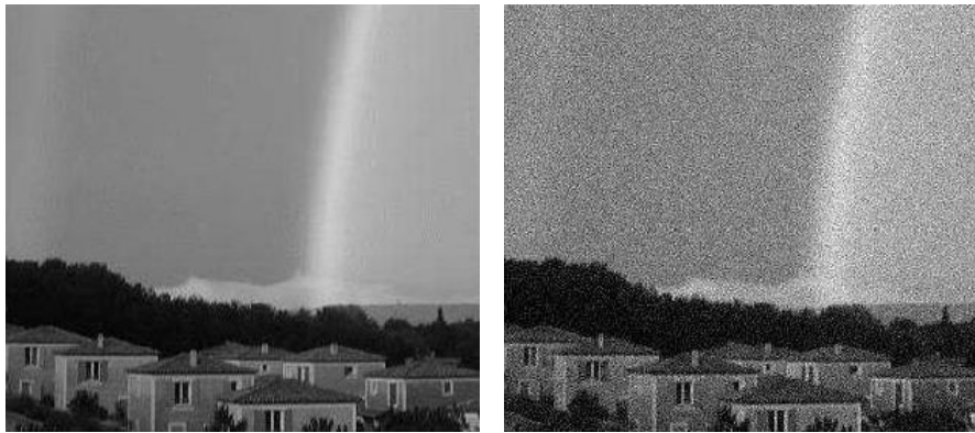
Figure 2.25 : A gauche l'image originale et à droite la même image bruitée par un bruit blanc.
