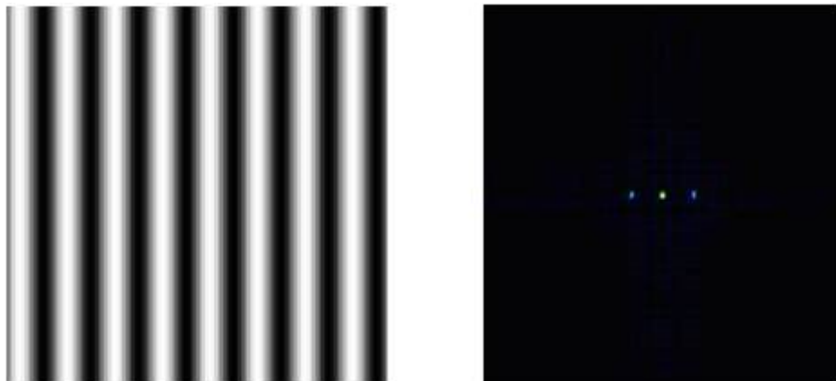
Figure 2.11 : Spectre d'une image de sinus horizontal.
