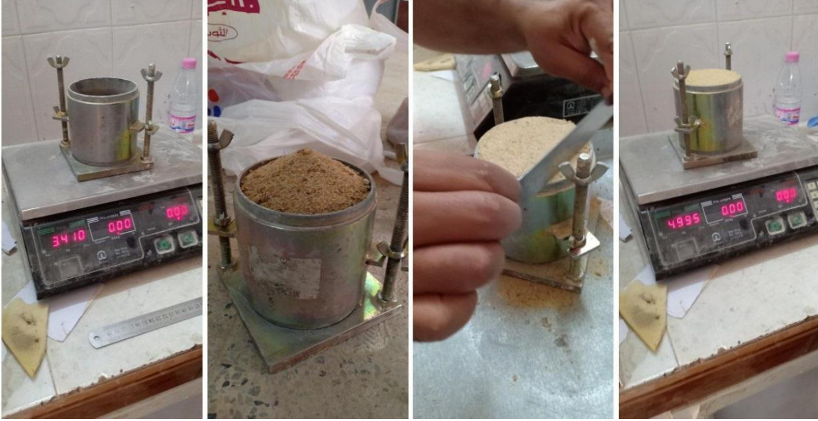
الشكل 16: خطوات تجربة الكتلة الحجمية الظاهرية
