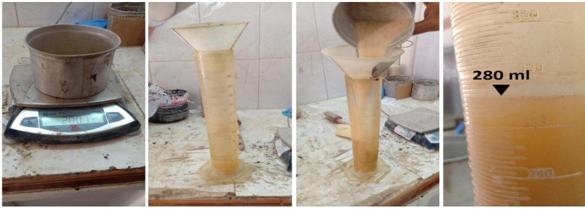
الشكل 15: صور خطوات تجربة الكتلة الحجمية المطلقة
