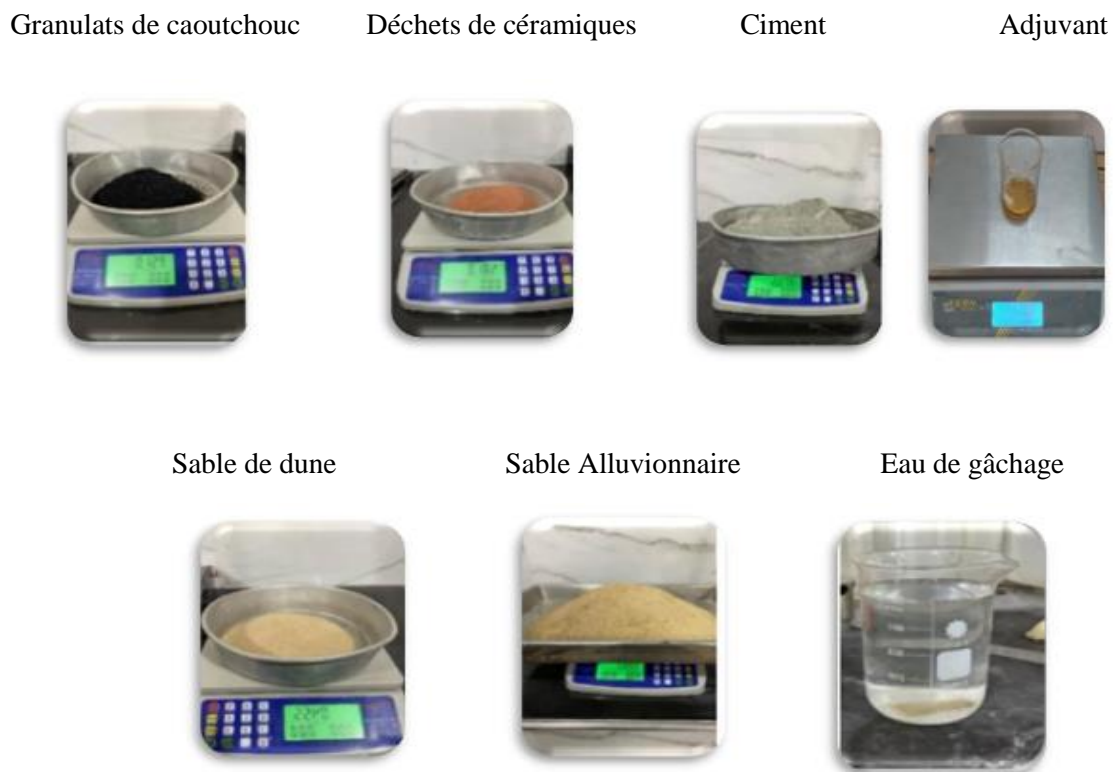
Figure II.9. Pesage des composants du béton de sable
