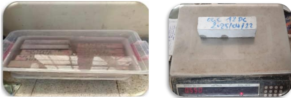
Figure II.26. Essai par immersion totale d'eau par.
