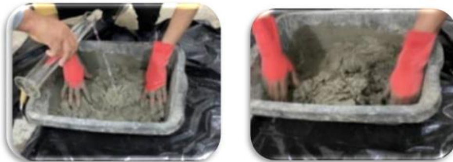
Figure.II.12. Ajouter de l'eau en mélangeant
