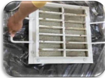
Figure.II.16. Décanter l'échantillon en secouant
