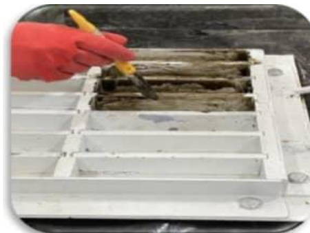
Figure.II.14. Lubrifié de moule
