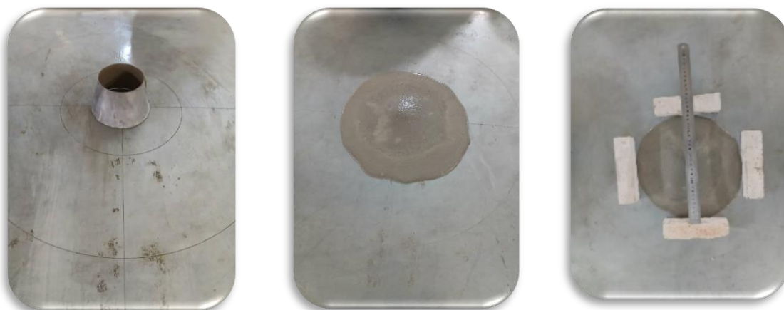
Figure.II.20. Essai d'étalement au mini cône.
