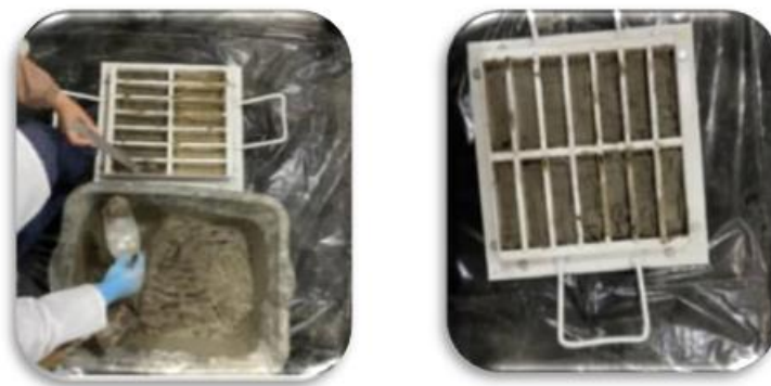
Figure.II.15. Verser la mmolette de la quantité dans le moule
