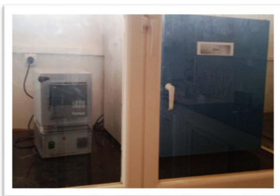
K: autoclave et etuve (incubateur 37°C)
