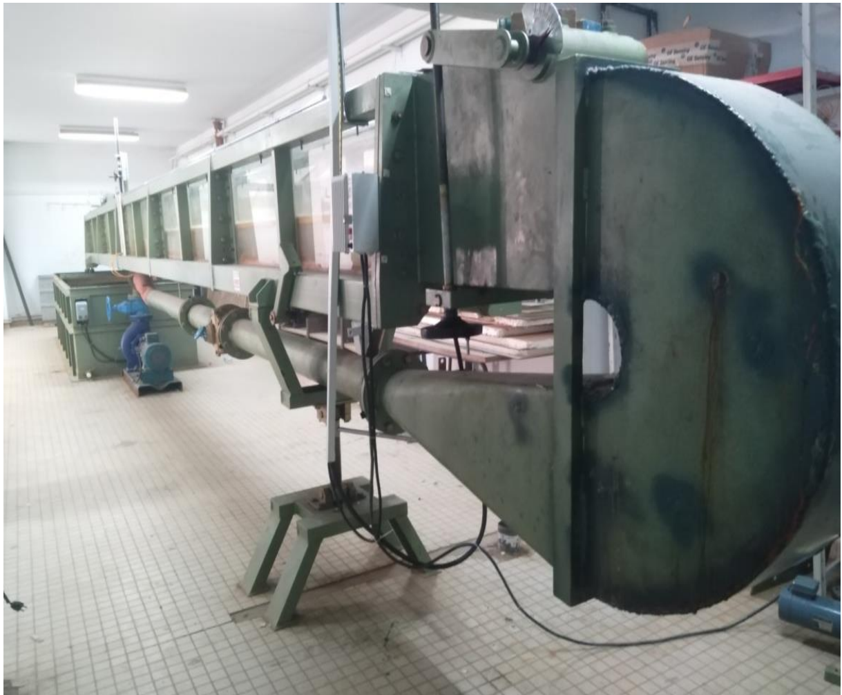
Figure 2.1: photographie du canal d'expérimentation(Laboratoire Université Ouargla).
