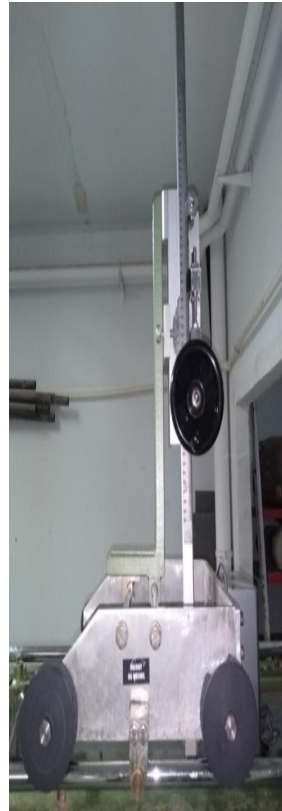
Figure 2.7: La profondeur d'eau mesurée par pointe limnimétrique (Laboratoire Université Ouargla).
