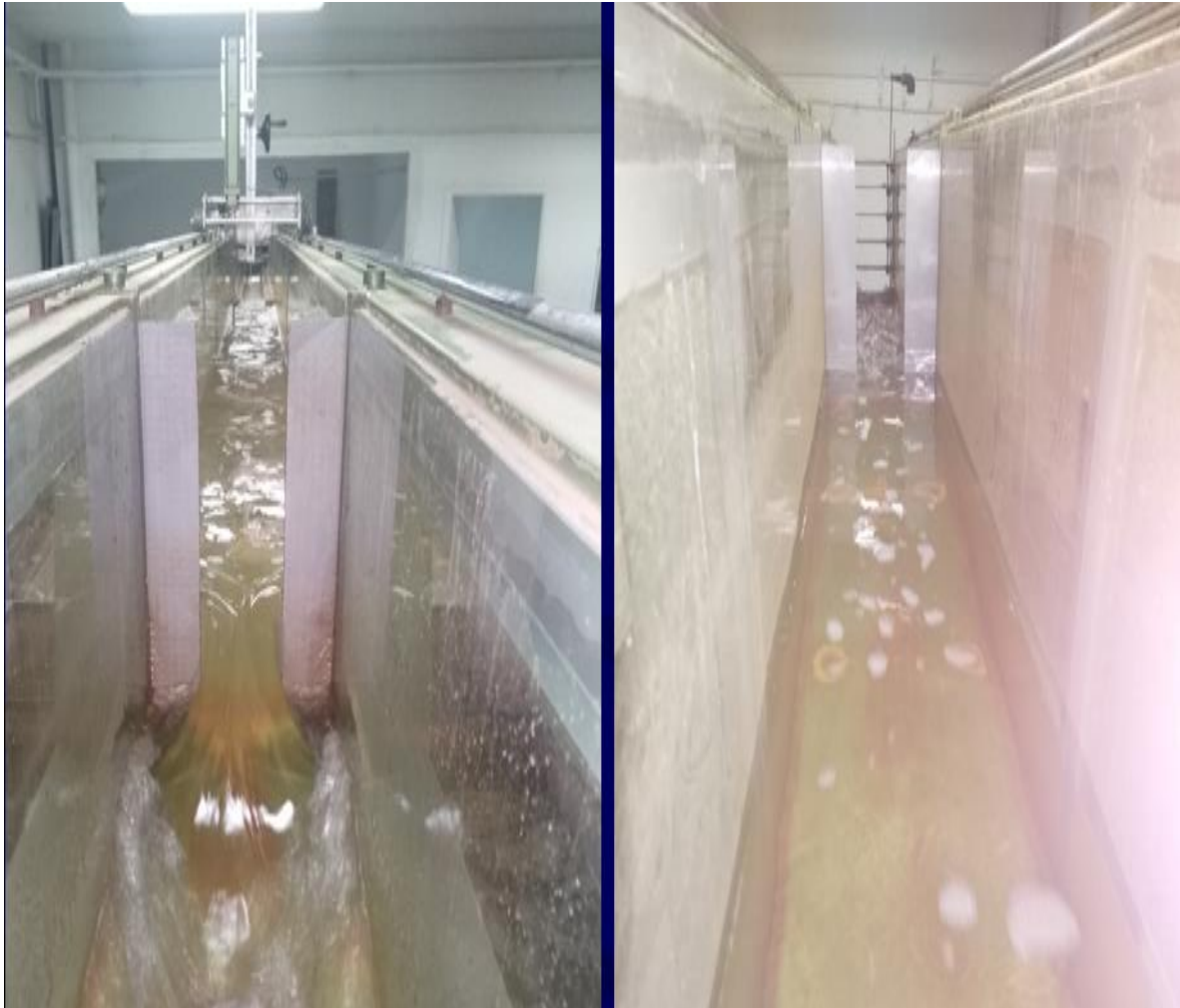
Figure 2.5: Photographie du déversoir rectangulaire avec contraction latérale pour mesurer les débits pompés(Laboratoire Université Ouargla).
