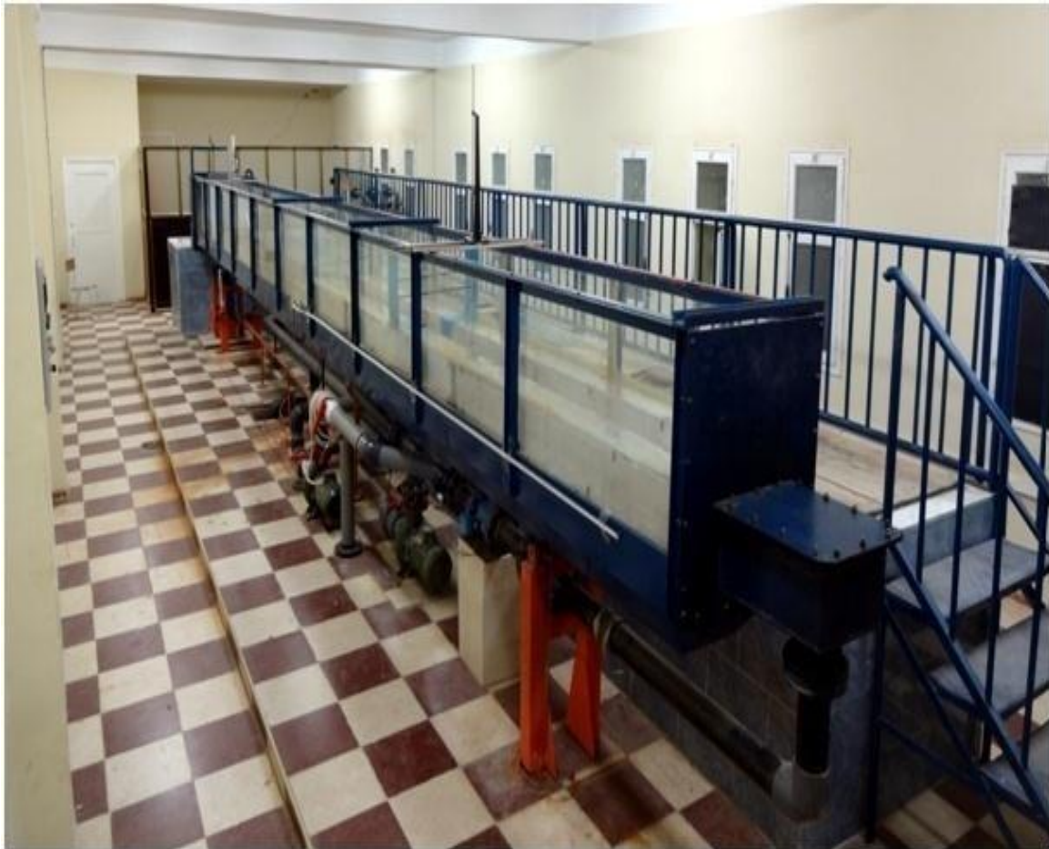
Figure1. 5: Photographie du canal ayant servi à l'expérimentation (laboratoire larhyss de Biskra)
