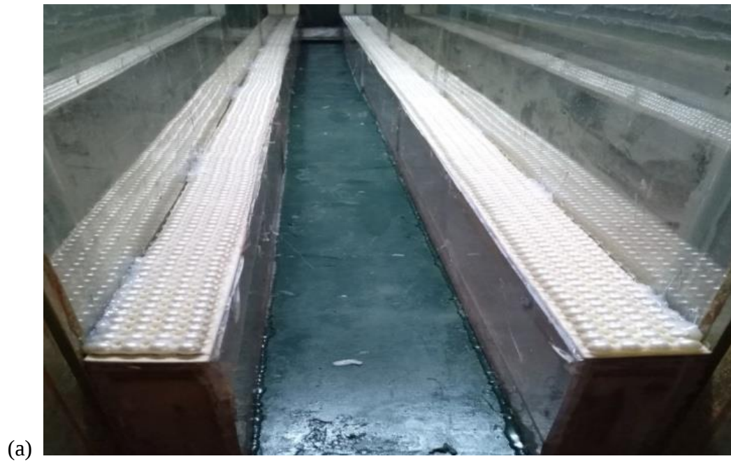
Figure 2.11: Photographie des tapis rugueux imposés au lit majeur du canal composé . a) canal avec fond lisse. et avec lit majeur rugueux(Laboratoire Université Ouargla).
