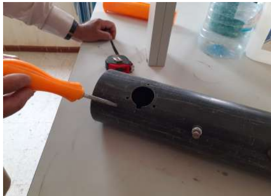
شكل 3.4: صورة توضح تحضير فتحة العدسة العينية وثقوب تثبيت المرآة الثانوية.
