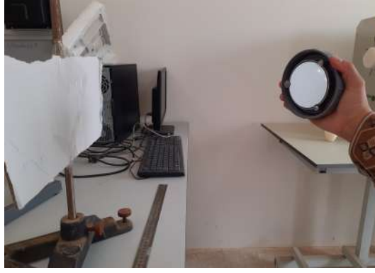
شكل 10.3: صورة توضح كيفية قياس البعد البؤري.
