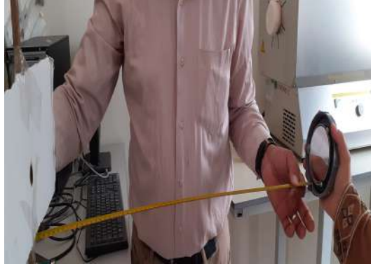
شكل 11.3: صورة توضح كيفية قياس البعد البؤري.
