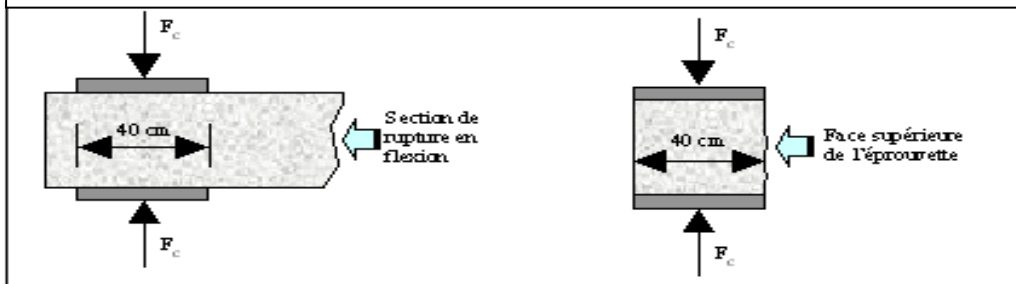
Fig4.09: Efforts appliqués sur une éprouvette pour le Flexion et la
