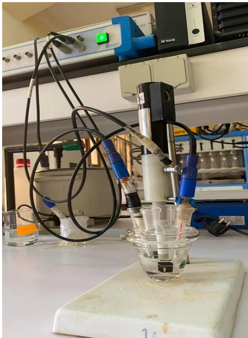
Figure.I.27 :La cellule électrochimique
