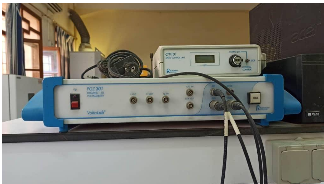
Figure.I.26.Dispositif expérimental utilisé pour la mesure des spectres de l'impédanceélectrochimique.
