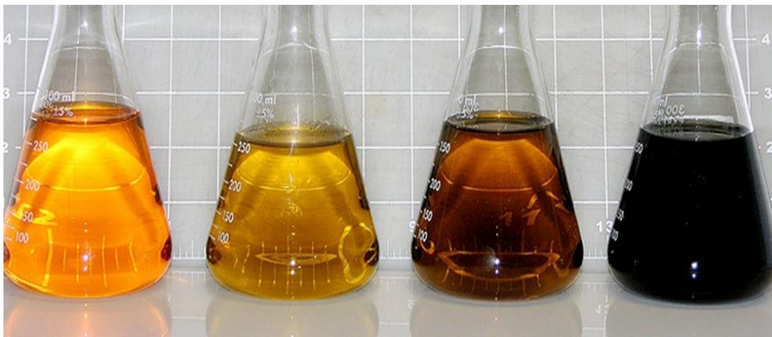
Figure II.5 Dégradation de liquide isolant au cours de vieillissement thermique (changement de couleur).
