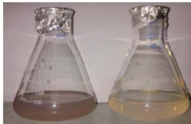
الصورة ( II- 5) : تكوين جزيئات أكسيد النحاس النانومترية [22].
