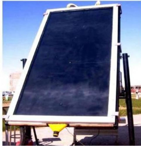
Figure II. 05 : Capteur solaire plan à air exposé au soleil [36].
