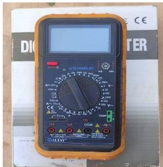
Photo.III.8 : Multimètre utilisé pour la mesure de la température ambiante.
