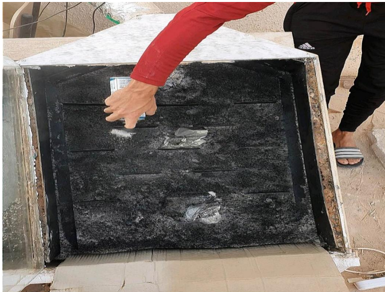
Photo.III.5 : Peinture du sel dans le capteur à chicanes.
