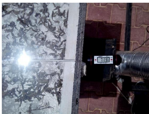
Figure III.4 : Mesure la température dans la chambre de séchage
