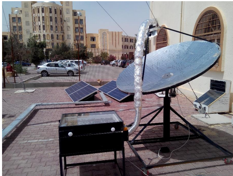
Figure II.8 : vue générale du séchoir solaire
