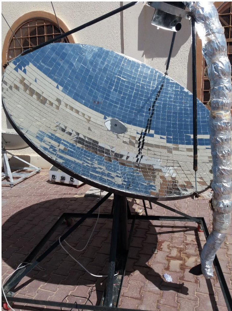
Figure II.2 : Le réflecteur à l'état final
