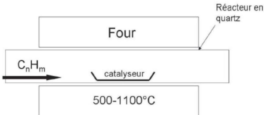
Figure II.2 : Schéma de synthèse par dépôt chimique
