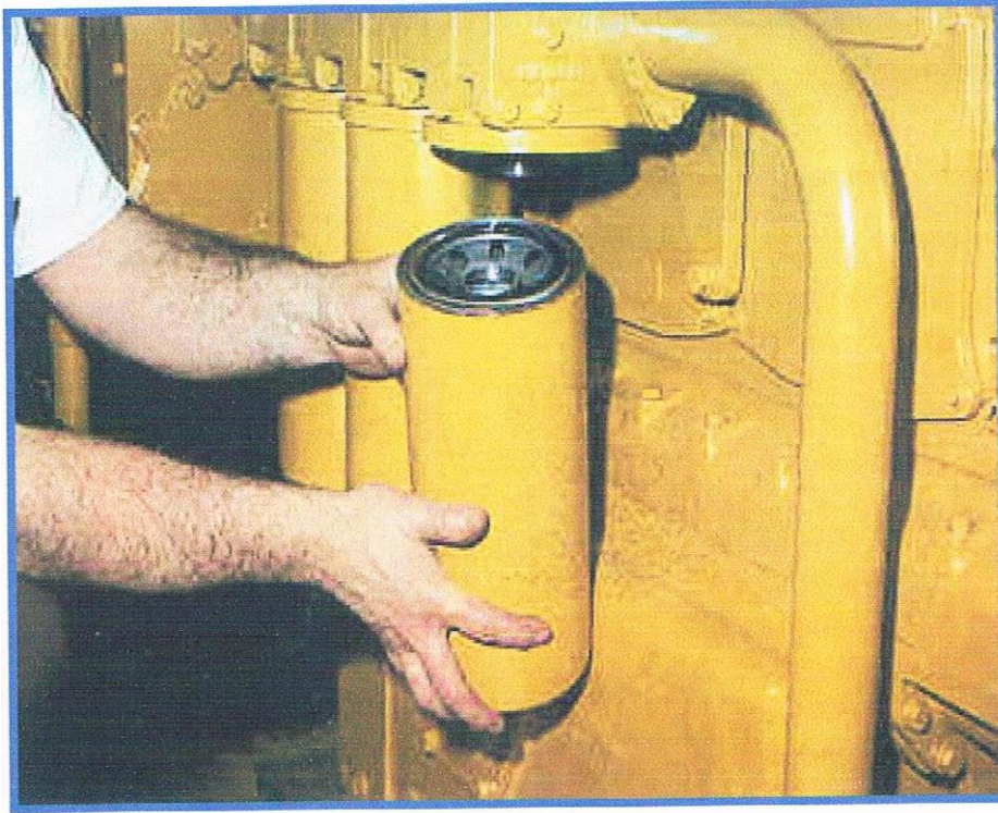
fig.II-5: Changement le filtre à huile
