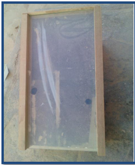
Fig. III.1.a: Corps du capteur étudié.
