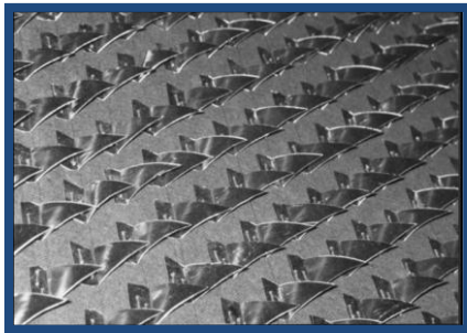
Fig. (I.2) : Disposition des obstacles DCL
