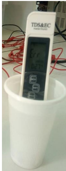
Figure III.4 Mesure conductivité (Yakamoz TDS&EC).
