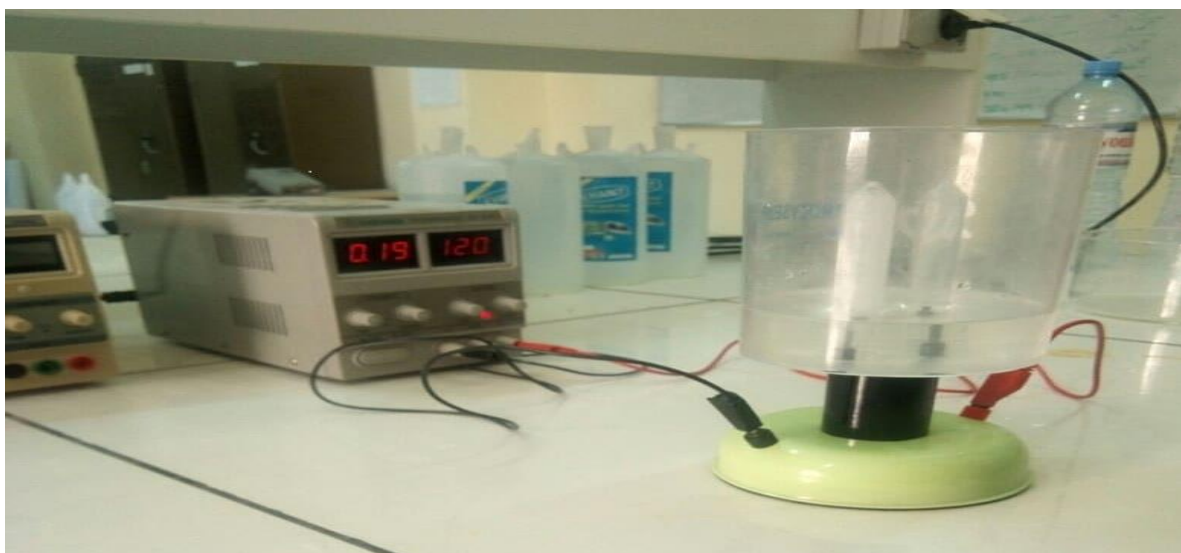
Figure III.2 : Schéma de l'électrolyseur de l'eau.
