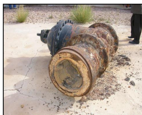
Phénomène d'entartrage à l'intérieur des conduites et des vannes dans la région d'Oued - Souf.
