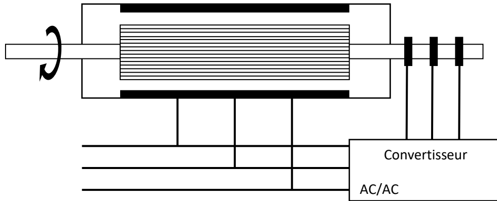
Figure I.2 : Schéma de principe de la machine à double alimentation standard.
