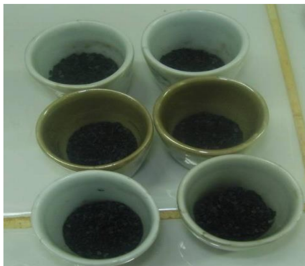
Figure 46: Charbon actif synthétisé à partir des noyaux de dattes
