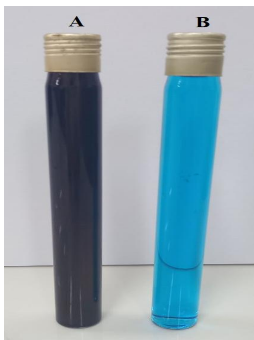
الصورة (4-1): التركيز الابتدائي للصبغة 300 mg/l (A) وبعد الامتزاز 37.56 mg/l (B)
