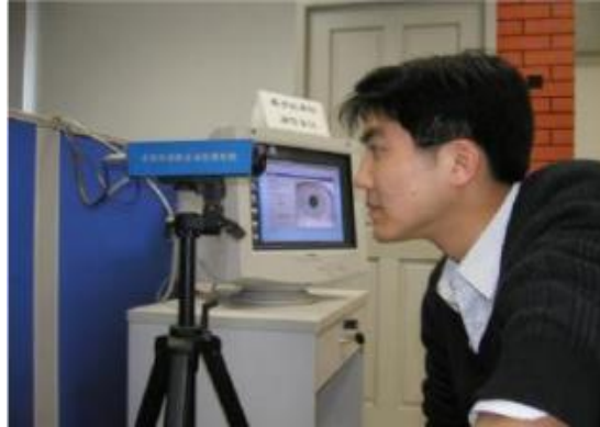
Figure (II.6): L'appareil développé par CASIA pour la collection de la base de données CASIA-IrisV1
