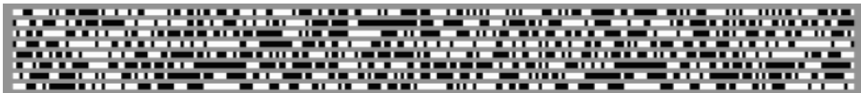
Figure II.14 Exemple de code d'iris généré par la méthode Daugman
