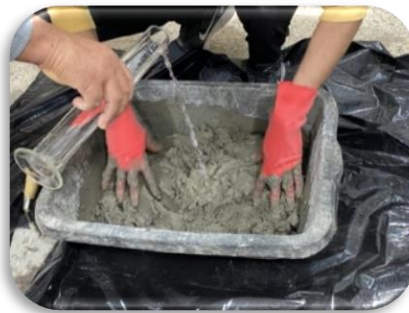
Figure. II.12. Ajouter de l'eau en mélangeant.
