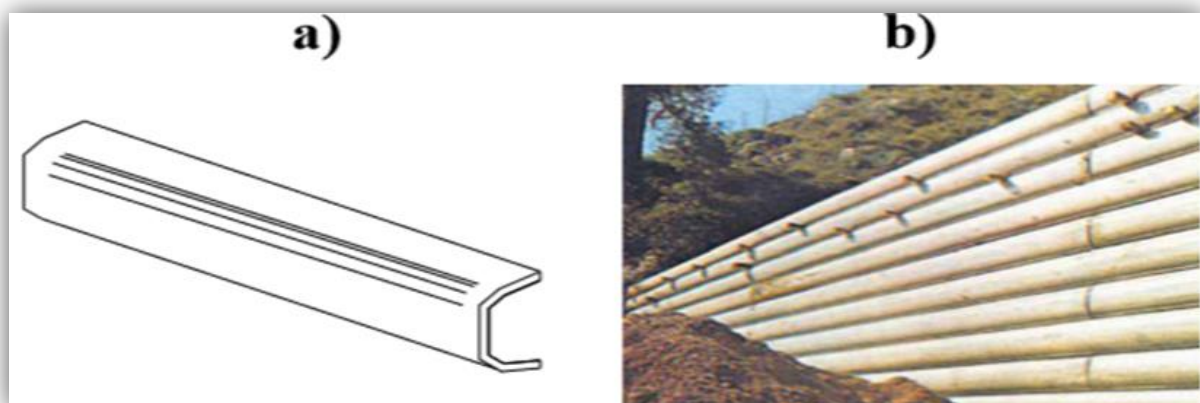
Figure II-14:Peau semi-elliptique en acier : a) NF EN 14475 ; b) Terre Armée
