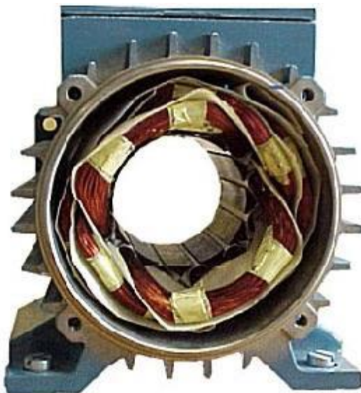
La Figure . I.2: Stator d'un moteur à induction.[3]
