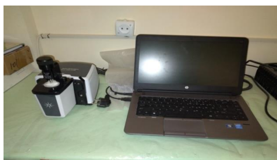
الشكل (14.III): صورة فوتوغرافية لجهاز مطيافية الأشعة تحت الحمراء FTIR. (الأصلي).
