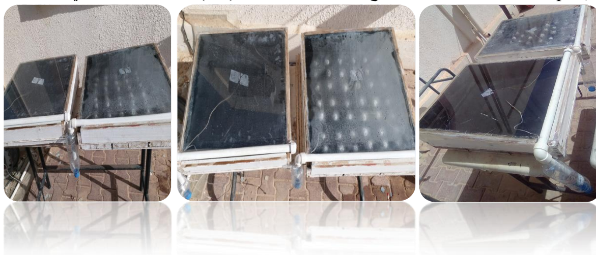
الشكل (3-9): المقطرات أثناء التجربة.
