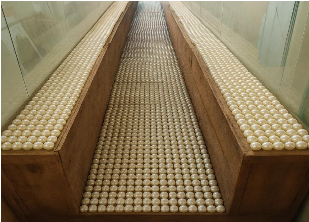
Photo 1.10: la pose des tapis préparés : a) canal rugueux.
