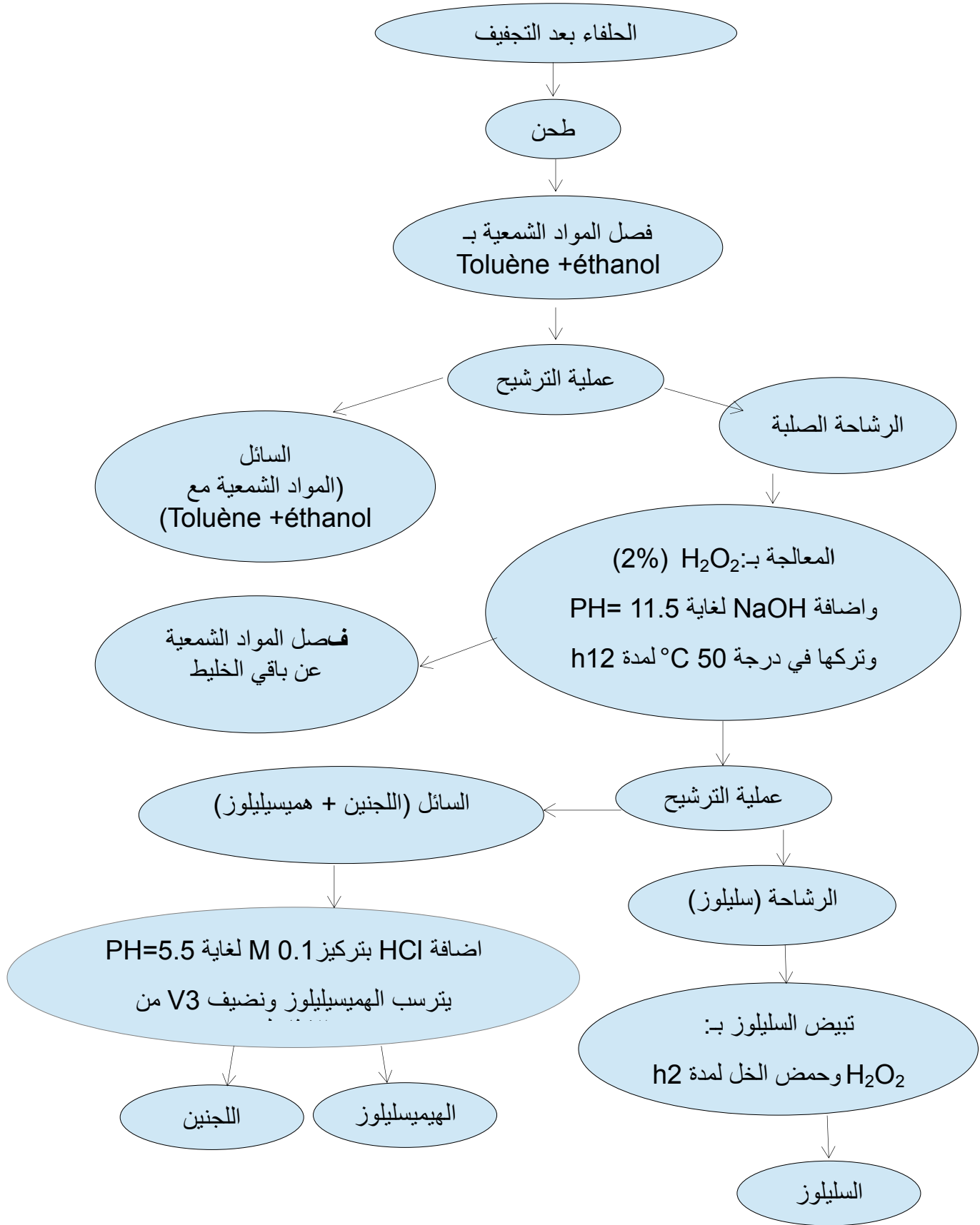
الشكل I - 7: مخطط استخلاص المواد اللجنوسيليلوزية (السليلوز، الهيميسيليلوز واللجنين)
