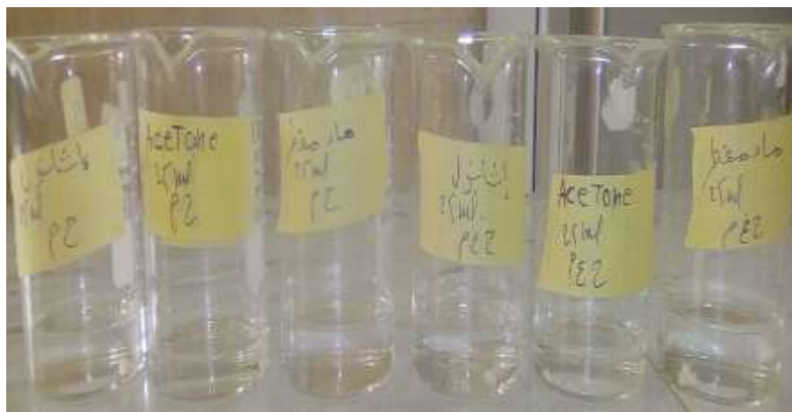
الصورة I-33: تجربة قابلية ذوبان السيليلوز في المذيبات ( الماء المقطر, الايثانول و الأسيتون)
