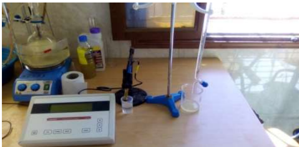
الصورة 24-I: معايرة المحاليل ب HCl ( 0.1M )
