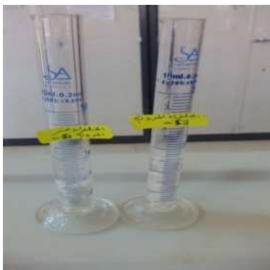
الصورة-I-32: دراسة قابلية امتصاص السيليلوز للماء
