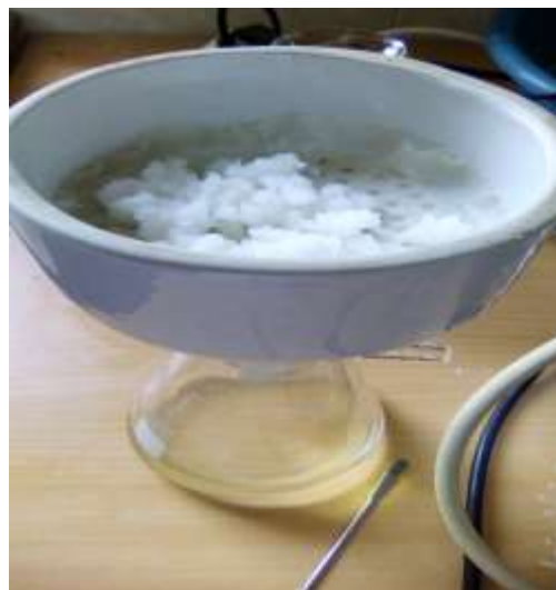
الصورة I- 22: غسل سيليلوز
