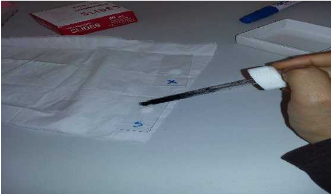
Préparation de l'échantillon du lait pour déterminer la taille de globules gras
